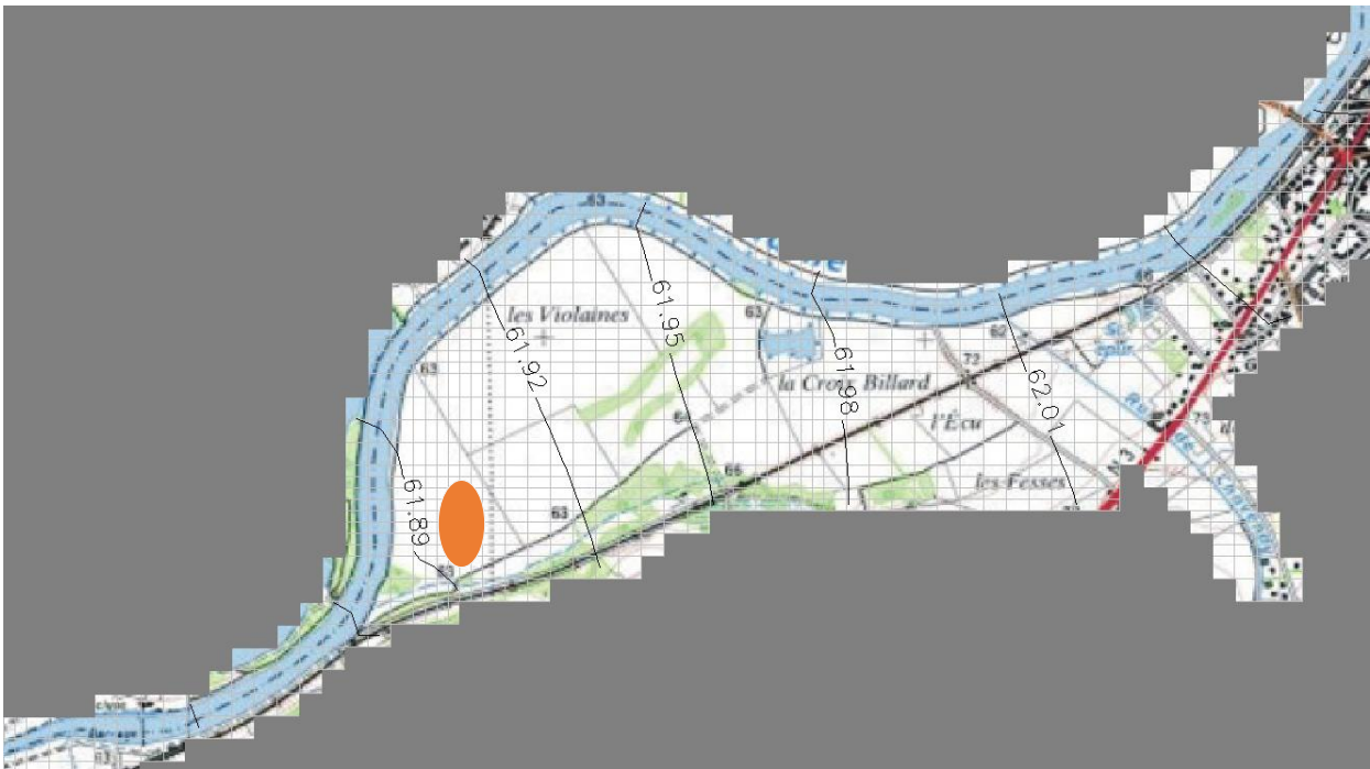
Figure 19 : Modélisation piézométrique à l'état initial
